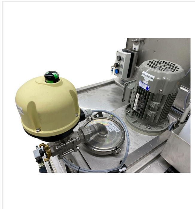
Schmutzwassertank mit integriertem Zulaufgrobfilter (<5 mm) sowie Rührvorrichtung
