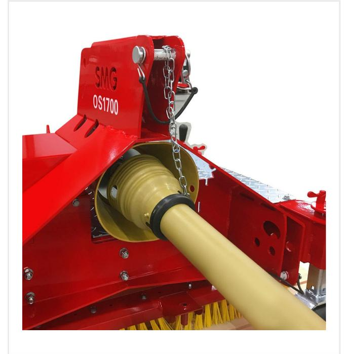
**Zapfwelle mit Heckdreipunktaufnahme,
