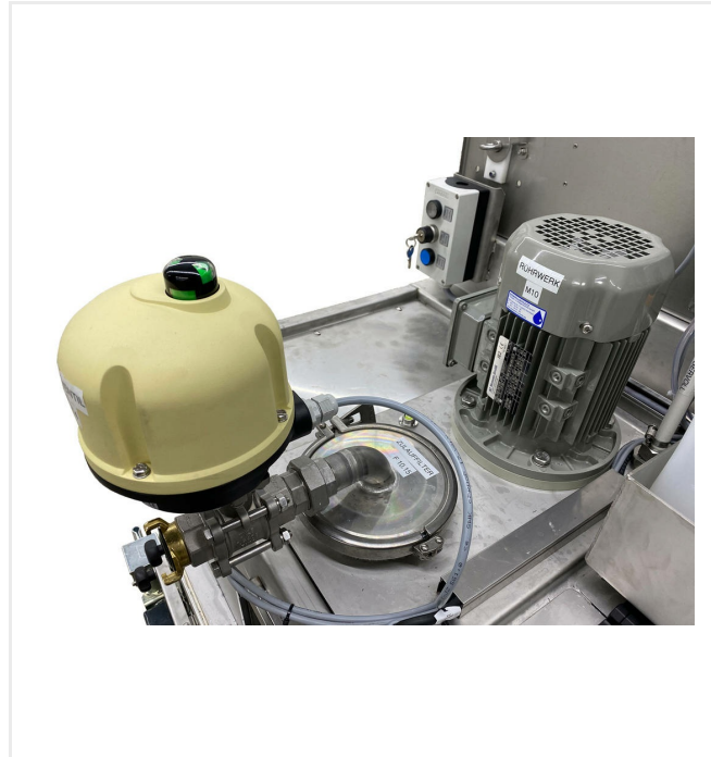
Schmutzwassertank mit integriertem Zulaufgrobfilter (<5 mm) sowie Rührvorrichtung
