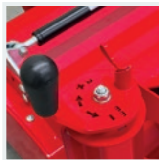
PRÄZISION: Spindeln zum exakten Einstellen und Fixieren der Arbeitstiefe.
