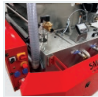
Zentraler Schaltkasten mit Display zur Ansteuerung sämtlicher Pumpen etc.
