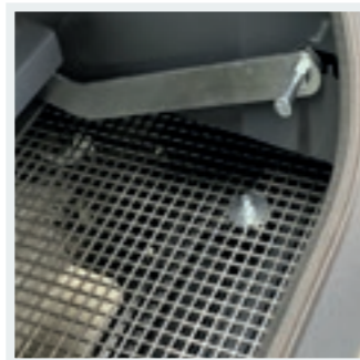
VARIABEL: Einstellbarer Schieber zum Einstellen von Materialfluss und Siebzeit.
