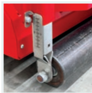
KONTROLLE: Skala zur Kontrolle von Arbeitstiefe und Niveau.
