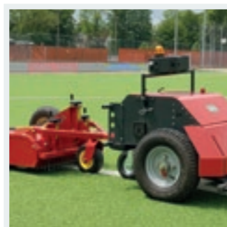
TURFCARE TCA500: Radgetriebenes Anbaugerät für die Reinigung und Pflege von Kunstrasen, Arbeitstiefe der Rotationsbürste und Federzinkenreihe sowie Sieblochung des Rüttelsiebes sind einstellbar; Arbeitsbreite 500 mm.
