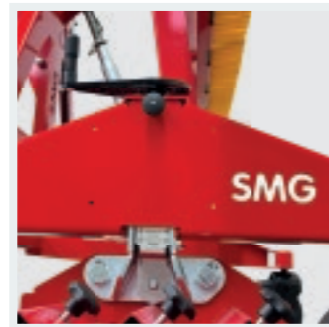
PRÄZISION: Einstellspindeln mit Arretierung und Skala.
