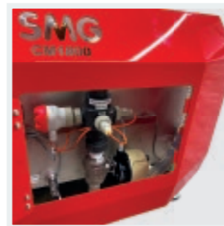
Sensorik zur Überprüfung von Trübung, Durchfluss und Füllständen
