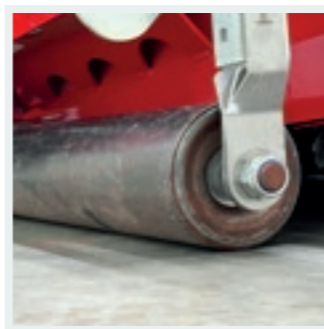
SCHONEND: Tastwalze für minimalen Flächendruck.
