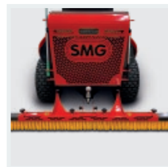
Arbeitsbreite Heckbesen erweiterbar von 800 mm auf 1.200 mm
