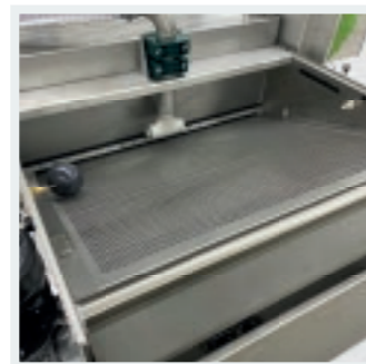
Bandfilter mit reißfestem Filtervlies (120 µm) inkl. Auffangbehälter mit Schwimmerschalter
