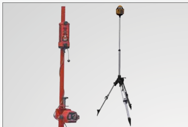
Optionale Lasersteuerung für exakte Einbaustärken
