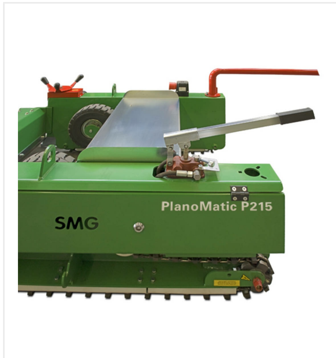
Bomba de mano hidráulica para extender y retraer el chasis
