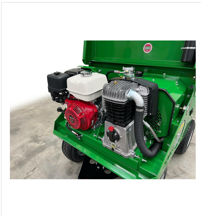
Motor de gasolina refrigerado por aire, para el accionamiento de la bomba y el compresor (motor eléctrico disponible)
