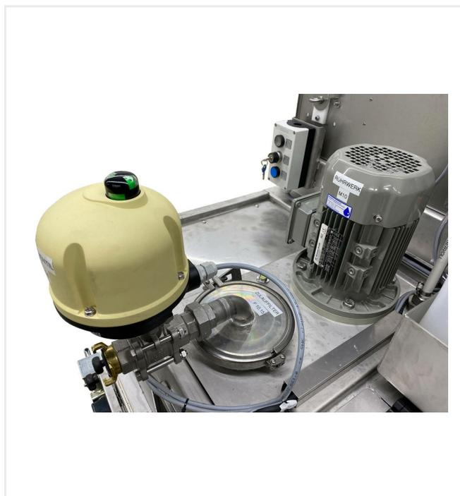
**Réservoir d'eau sale avec filtre d'entrée intégré (<5 mm) et dispositif d'agitation**
