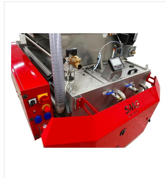
**Boîtier de commande central avec écran pour la commande de toutes les pompes, etc.**
