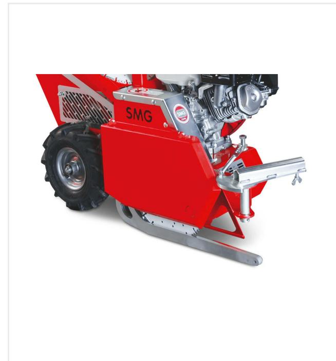
Lame, lame de scie et jauge orientable à 180°
