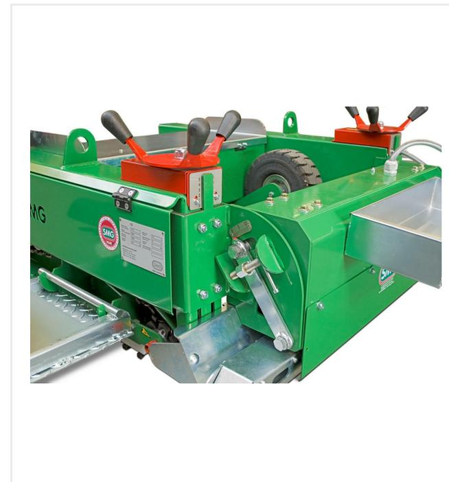
**Réglage de l'inclinaison de la règle à araser, volant à main molette pour régler l'épaisseur de pose**
