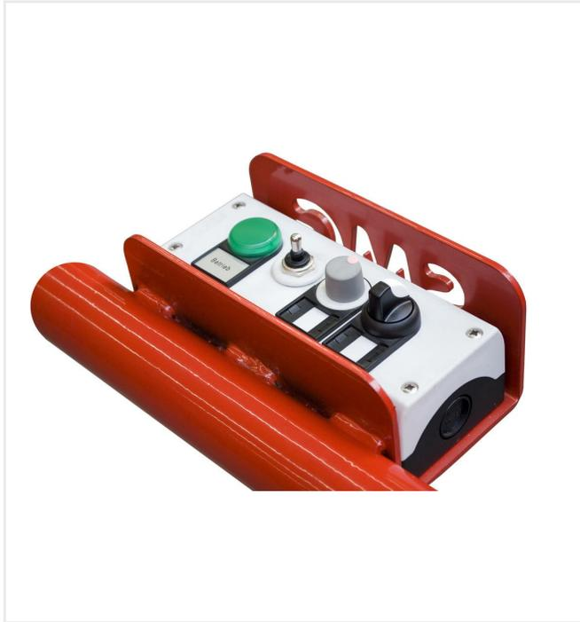
**Levier de direction, pouvant pivoter pour le transport, avec éléments de commande pour le déplacement en continu et l'oscillation de la règle à araser**
