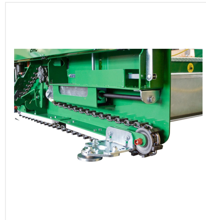
Rouleau déflecteur pour les travaux le long des pierres de bordure
