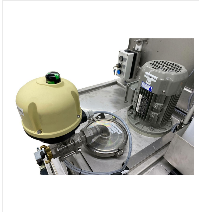
מיכל שפכים עם מסנן כניסה משולב (>5 מ"מ) וכן מתקן ערבוב
