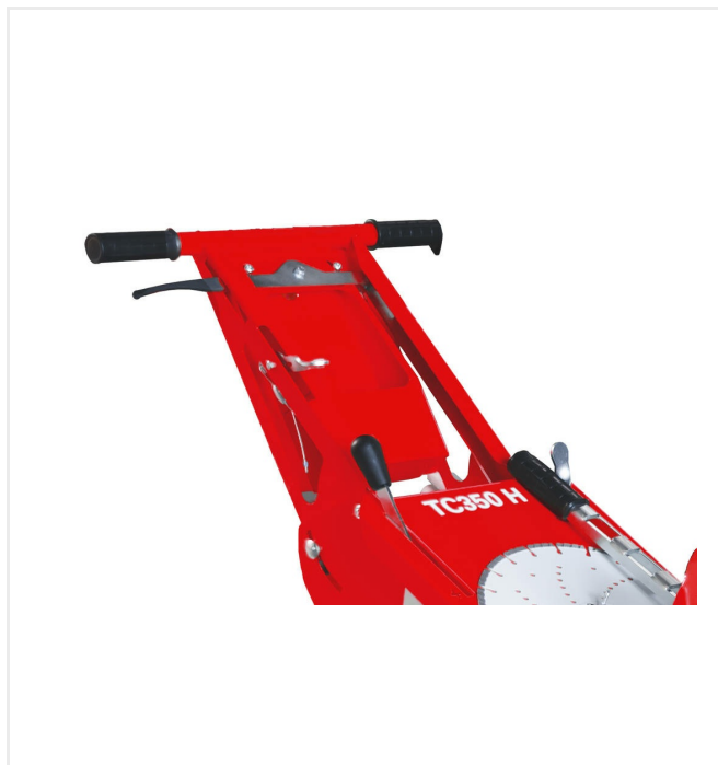
Hydrauliczny, bezstopniowy napęd jezdny
