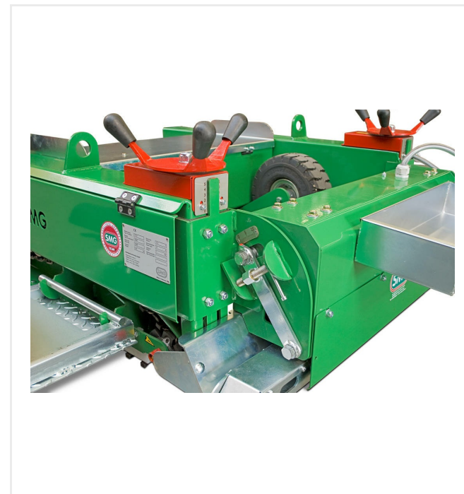
Регулировка угла наклона разравнивателя, ручной маховик для регулировки толщины укладки
