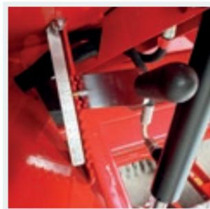
**PRÄZISE:** Materialauslass über Schieber exakt einstellbar.
