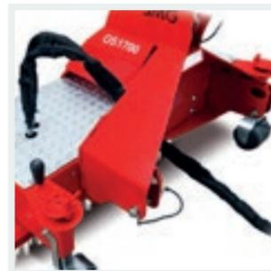
**HYDRAULIK:** OS1700 mit Heckdreipunktaufnahme, Antrieb hydraulisch.
