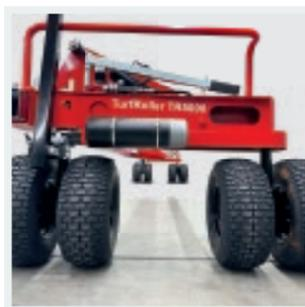
**LEICHTFÜSSIG:** 8 Räder mit Rasenbereifung für minimalen Flächendruck.
