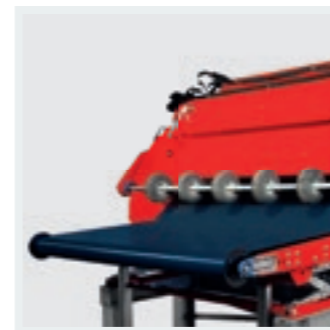
EFFIZIENTER TRANSPORT: Wickelband mit Spannrollen.
