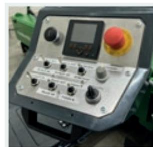
**DIGITALISIERUNG:** Steuerpaneel mit Display für IOT und GPS Anwendung.
