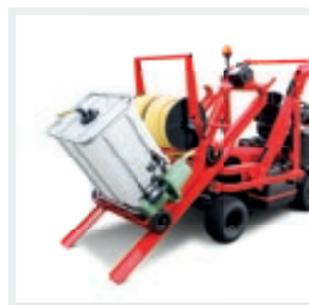
**INDIVIDUELL:** Rampe und Winde für Transportwagen mit 300 Liter Wassertank, Zusatzpumpe und 2x 75 m Schläuche.
