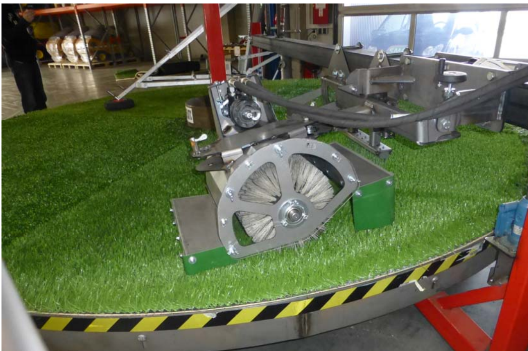
Rotationsbürste mit geöffneter Verschalung
