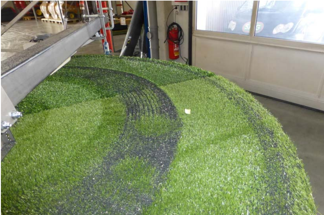
Belagsoberflächen nach 16 Umdrehungen
