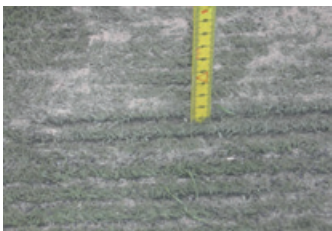
Zu wenig Füllmaterial zerstört die Fasern
