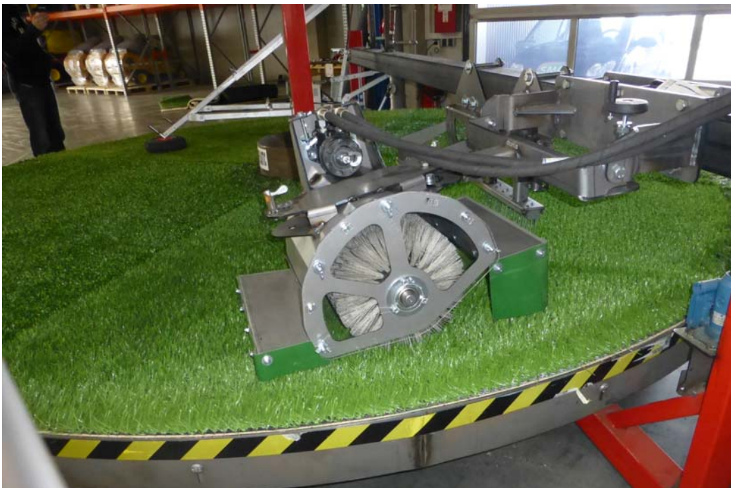
Rotationsbürste mit geöffneter Verschalung
