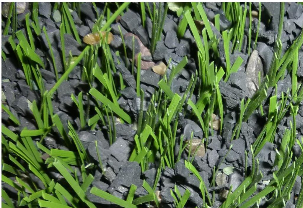
Foto 6: Superficie tras 32 giros: Cepillo rotativo. Grama sintética 1
