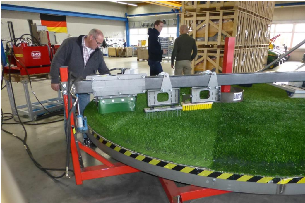
Foto 1: Plataforma rotativa con equipamiento de mantenimiento
