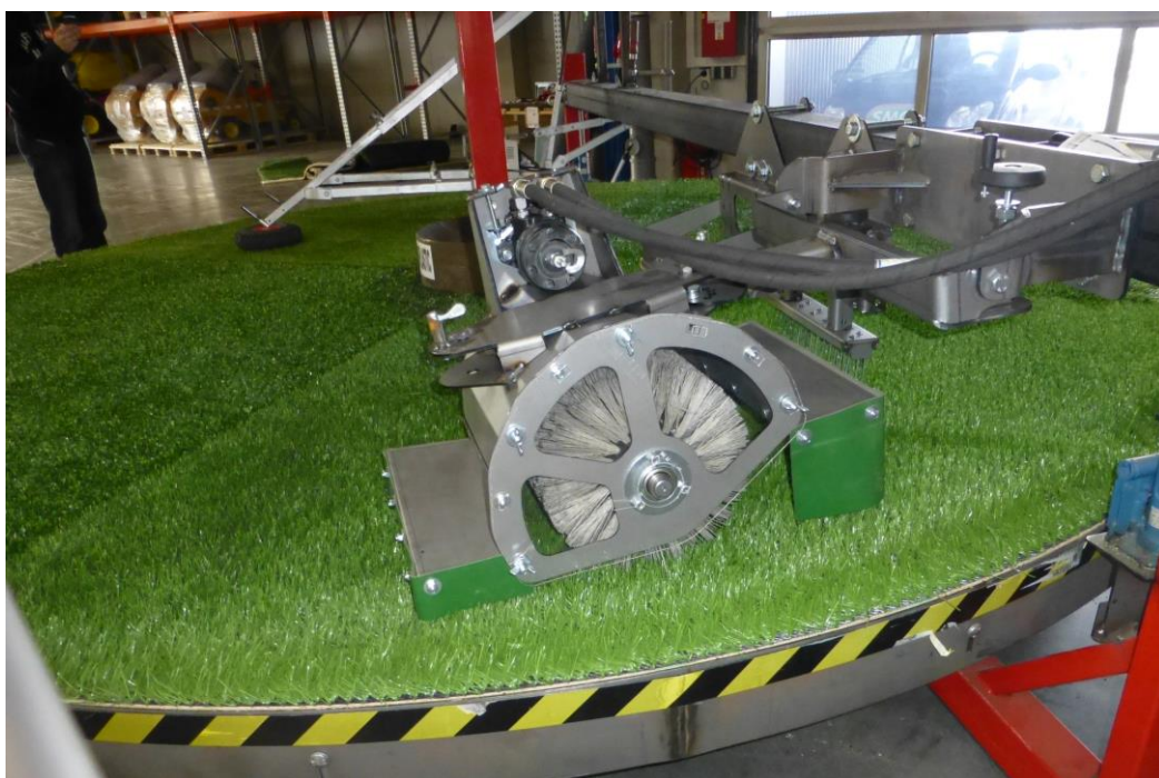
Foto 2: Cepillo rotativo con carcasa abierta
