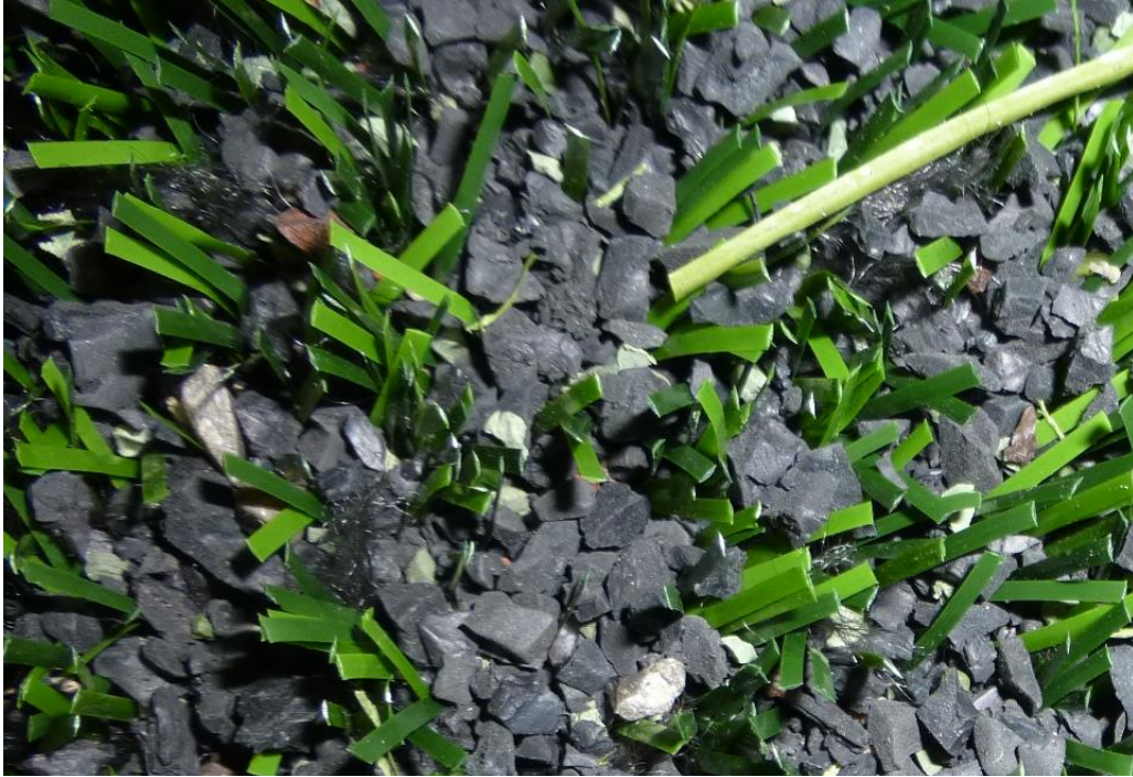
Foto 9: Superficie tras 32 giros: Cepillo rotativo. Grama sintética 4
