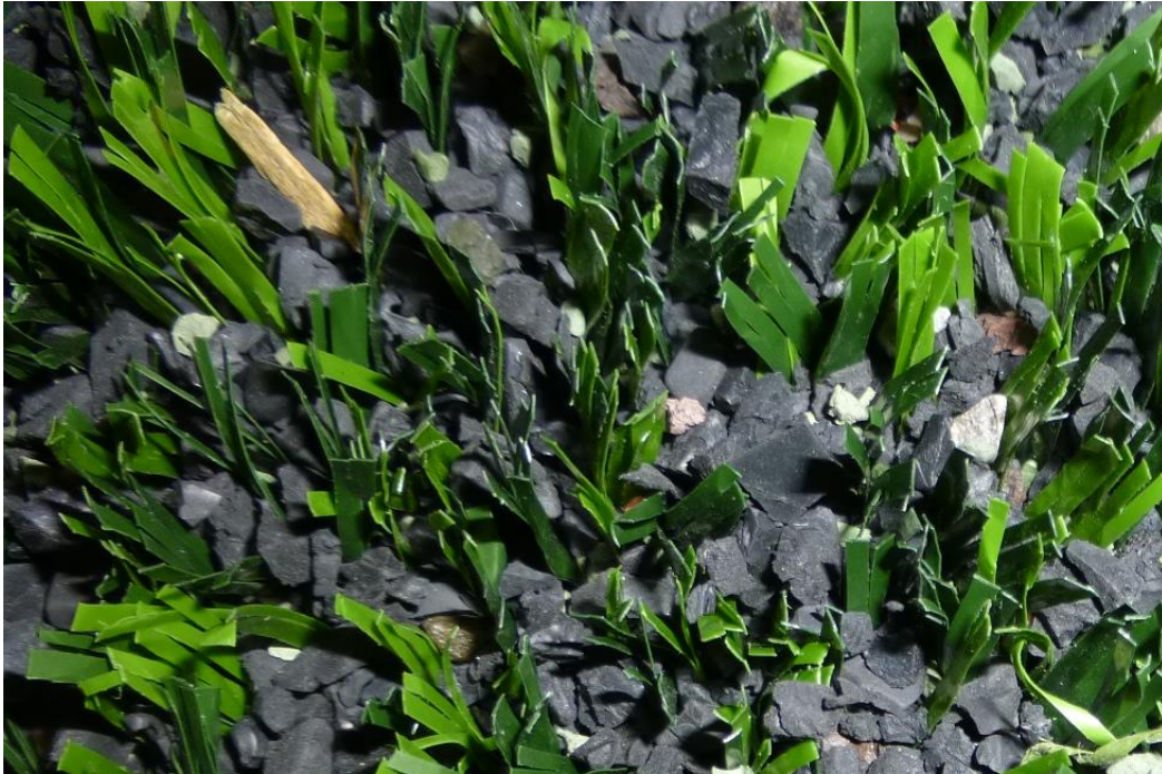
Foto 7: Superficie tras 32 giros: Cepillo rotativo. Grama sintética 2
