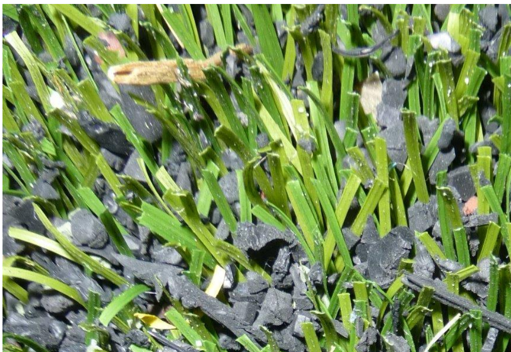
Foto 8: Superficie tras 32 giros: Cepillo rotativo. Grama sintética 3
