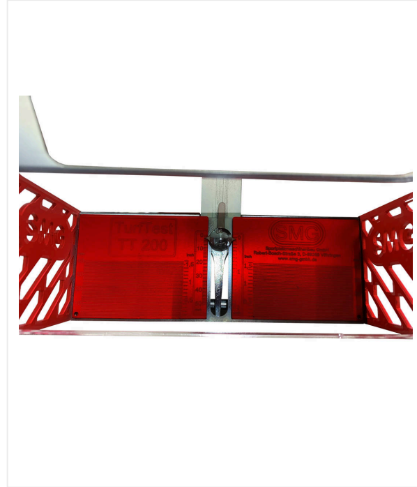
قياس الارتفاع الحر للكومة مقياس بوحدّة ملم/بوصة
