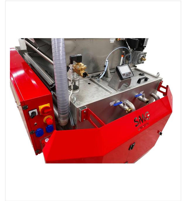
Zentraler Schaltkasten mit Display zur An- steuerung sämtlicher Pumpen etc.
