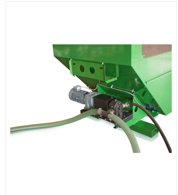
Ansaugpumpe und Bypass-Schlauch
