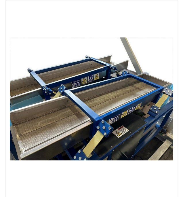
Sistema de desagüe por vibración
