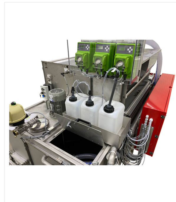
Réservoir et station de dosage pour floculant, en option détergent, etc.
