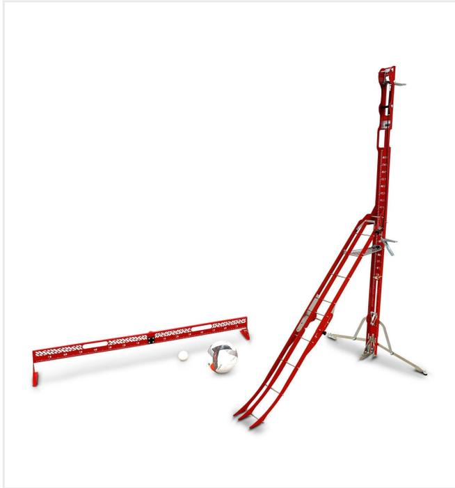
Rampe de contrôle du roulement et du rebond haut de gamme
