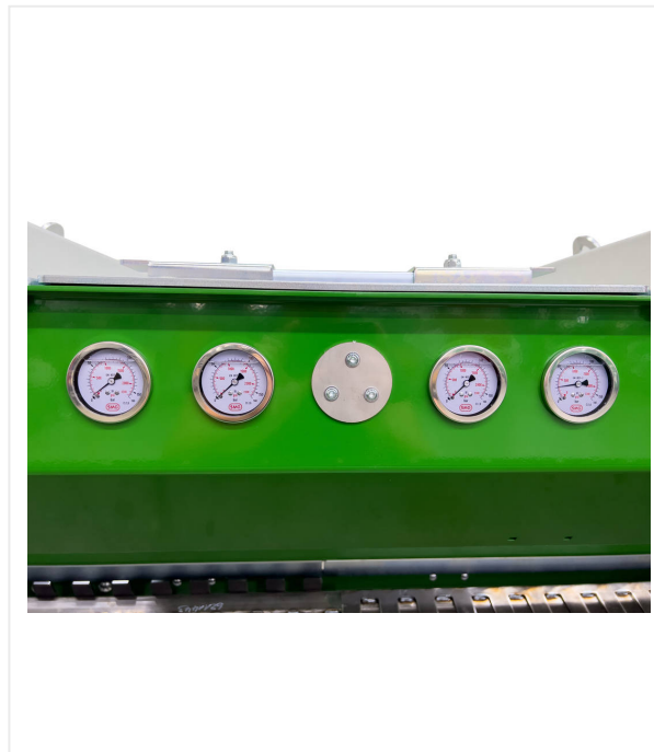
Manomètres pour les pressions hydrauliques
