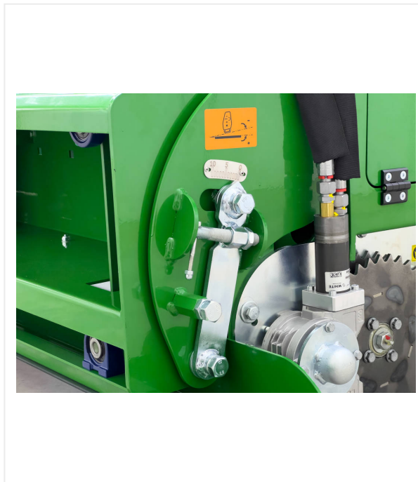
Réglage de la compaction
