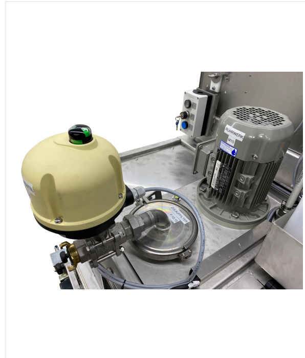
מיכל שפכים עם מסנן כניסה משולב (>5 מ"מ) וכן מתקן ערבוב
