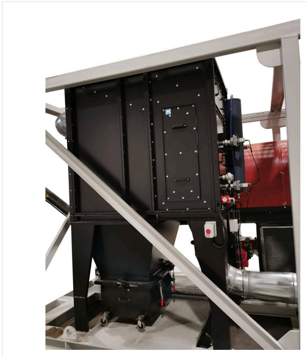
מערכת סינון קרטוש משולבת (הפרדת אבק דק >200 \mu\text{m} )
