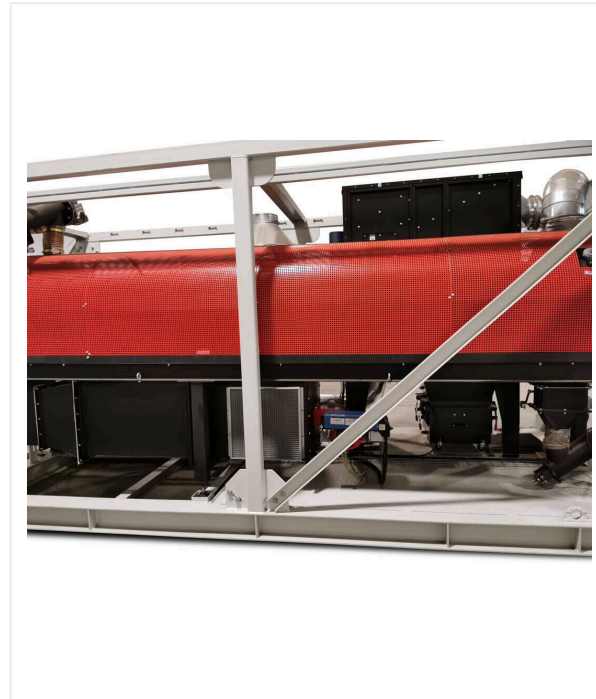
מייבש אוויר חם סיבובי עם יחידת מבער (הפעלה בדיזל, אופציונלי בגז פחמימני מעובה / גז טבעי)
