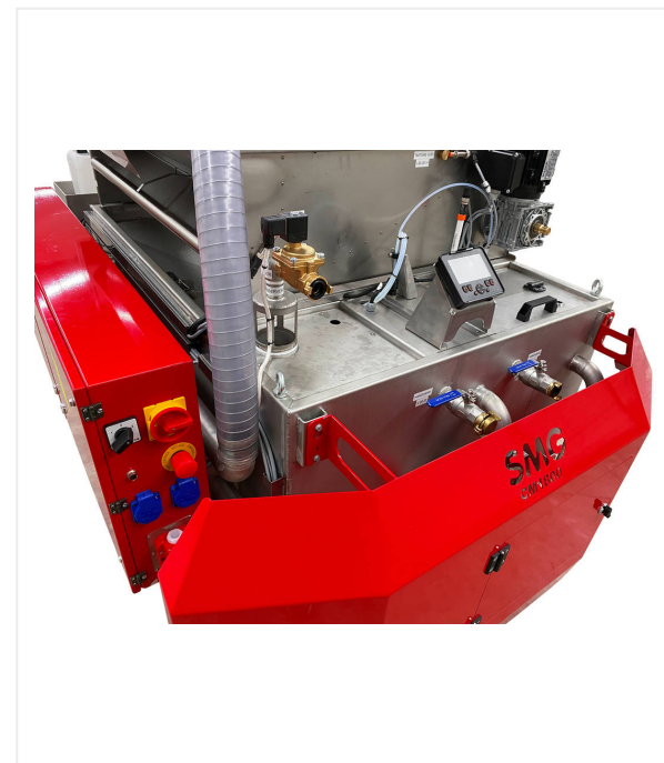
Centralna skrzynka sterownicza z wyświetlaczem do obsługi wszystkich pomp i innych elementów
