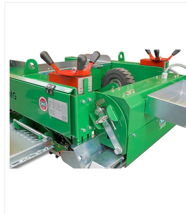
Regulacja pochylecia listwy wyrównującej, ręczne pokrętko do ustawienia głębokości osadzenia.
