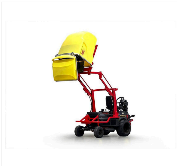
Гидравлический подъём контейнера
