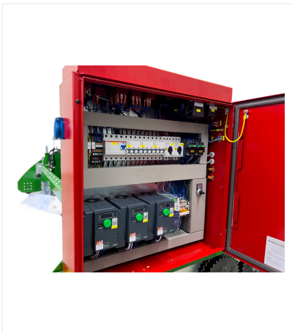
Распределительный блок с преобразователями частоты
