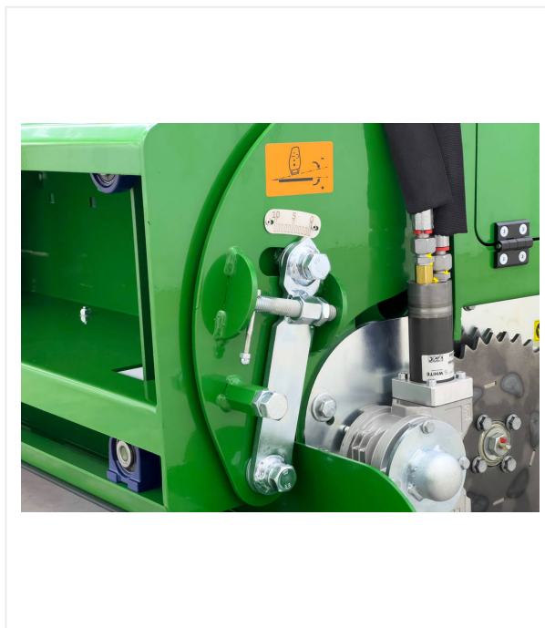
Регулировка степени уплотнения
