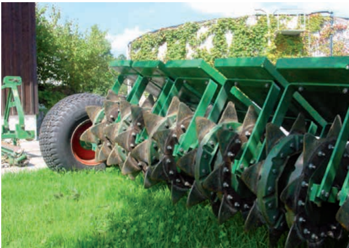
Abb. 42: Schlitzgerät mit schmalen, kurzen Messern zum Durchschneiden der Rasennarbe und Belüftung
