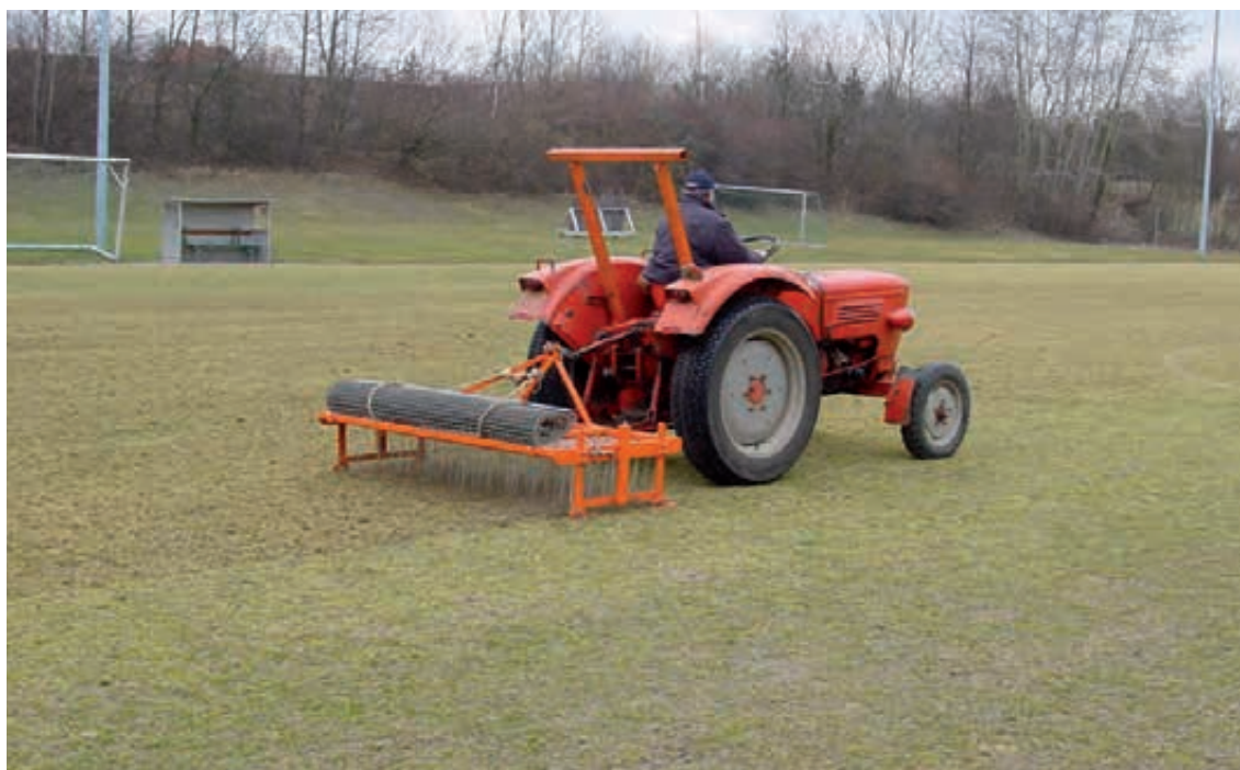
Abb. 40: Striegeln einer Rasensportfläche im zeitigen Frühjahr
