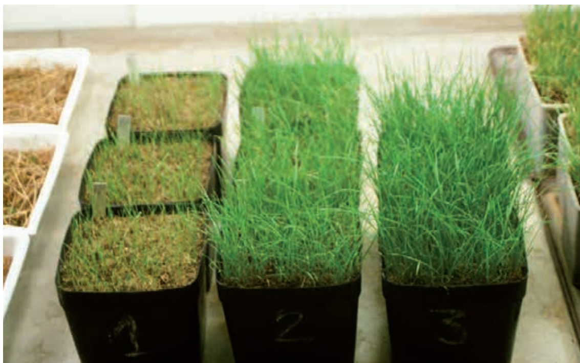
Abb. 61: Stickstoffmobilisierung aus Zusätzen einer Besandungsschicht Links: kein Zusatz; Mitte: geringer Zusatz; Rechts: größerer Zusatz
