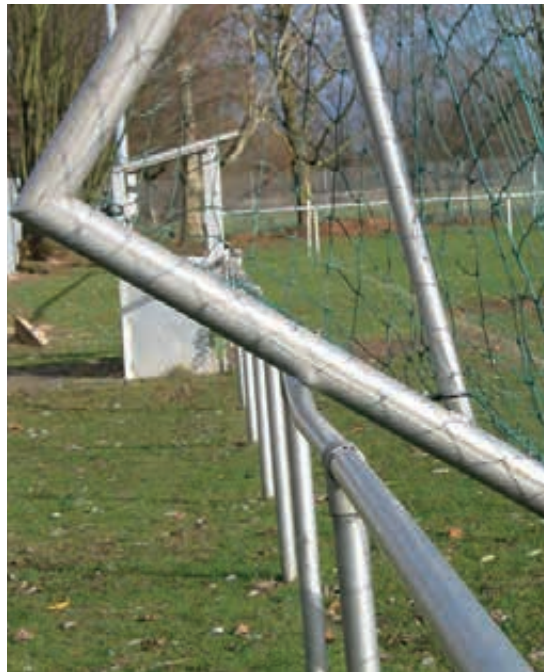
Abb. 15: Beschädigung der Barriere durch unsachgemäßen Transport des Tores
