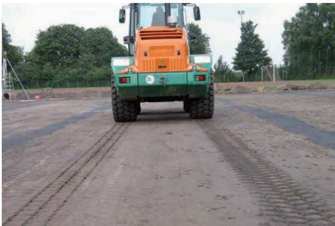
Abb. 73: Befahrungsversuch, keine Verformung
