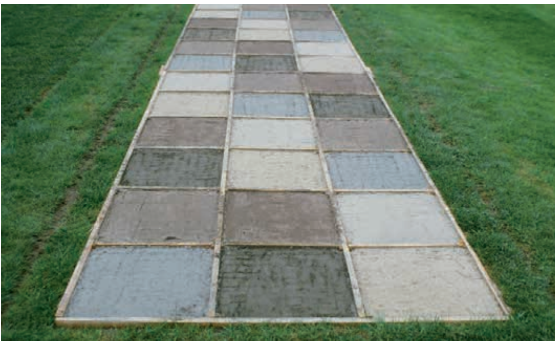
Abb. 35: Modellversuch mit verschieden zusammengesetzten Rasentragschichten vor der Ansaat
