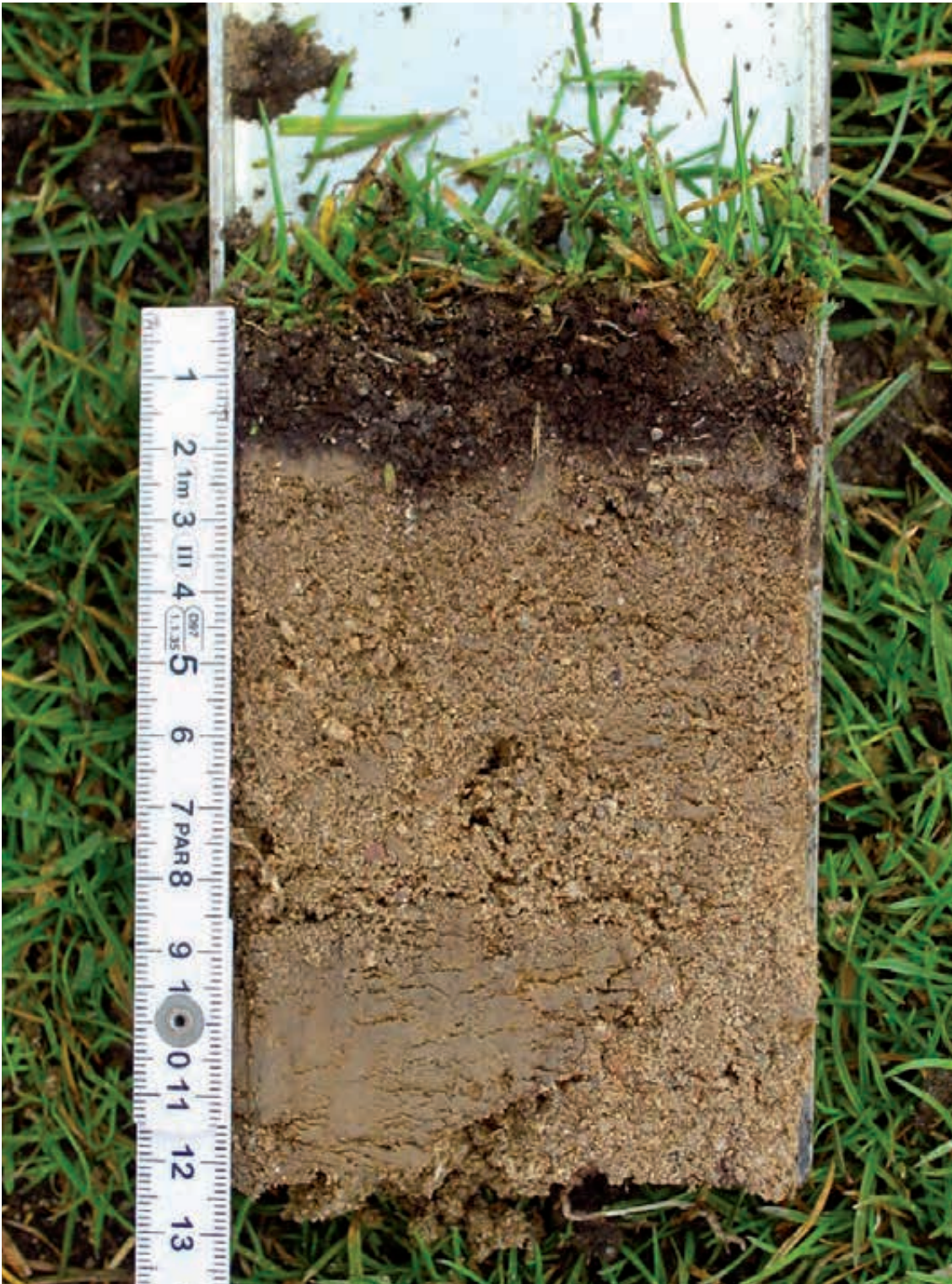
Abb. 39: Starke Rasenfzlbildung von 20 bis 25 mm Dicke auf einer Rasentragschicht; wenig benutzte und wenig bis nicht vertikutierte Sportflache
