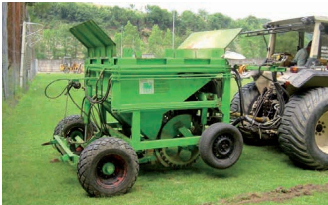
Abb. 62: Herstellen und Verfüllen schmaler linearer Sickerschlitz
