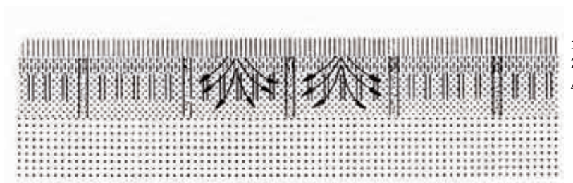
B Entwässerung des Oberbodens durch Sickerschlitze, kombiniert mit A, bei wasser- aufnahmefähigem Untergrund bzw. Unterbau.
