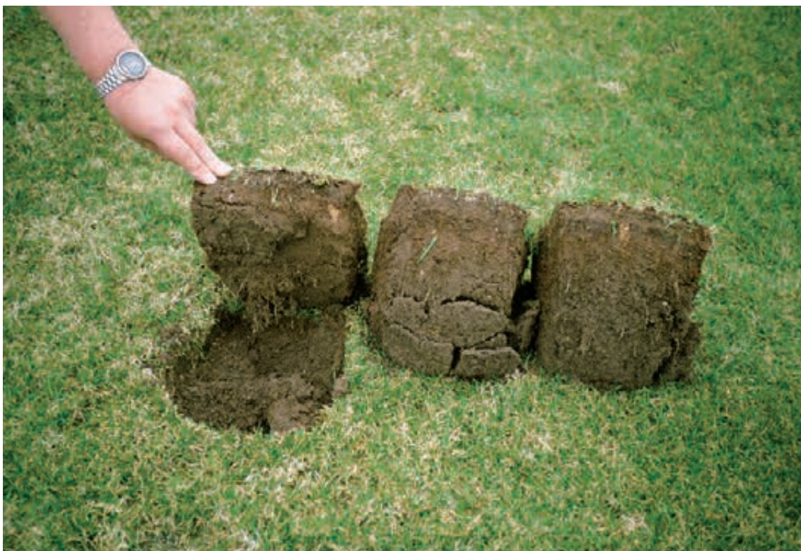
Abb. 60: Rasenbewurzelung nach lockerer Bearbeitung einer Besandungsschicht. Links: Unbearbeitete Kontrollfläche; Mitte: Vertikalfräsen; Rechts: Vertidränlockern
