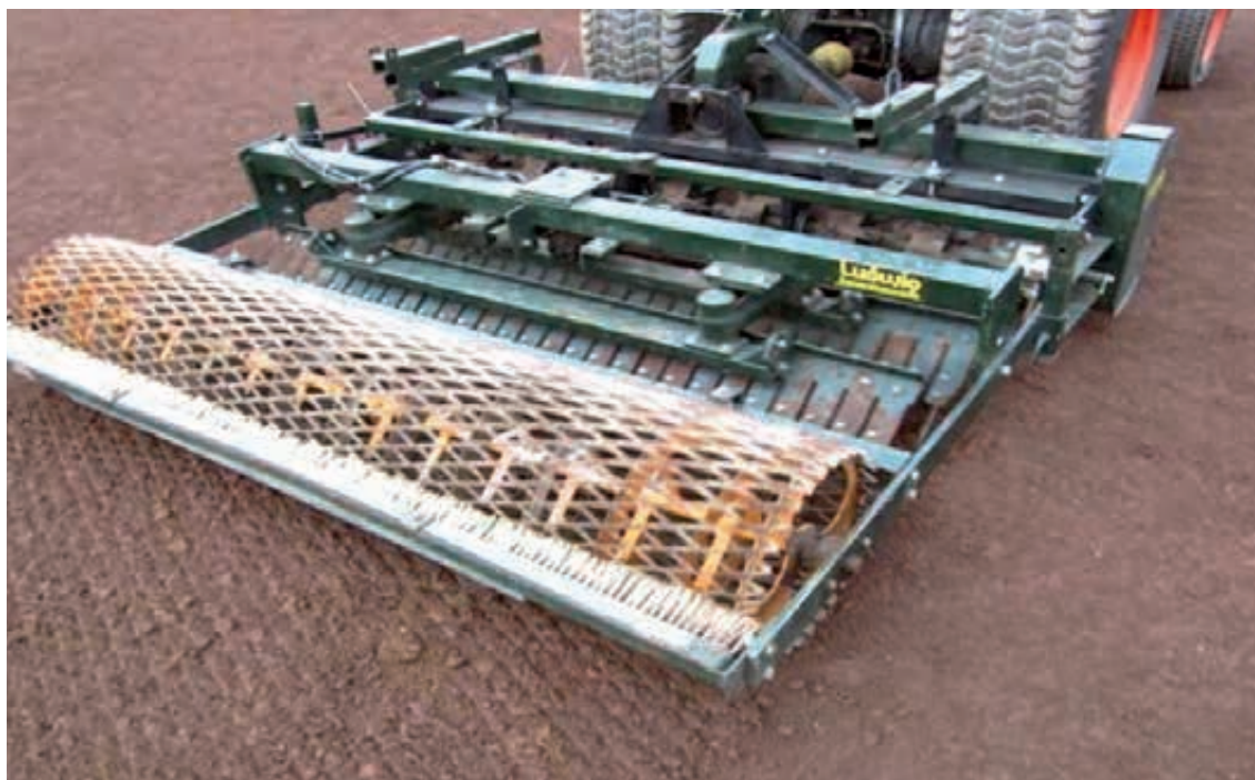
Abb. 77: Kombinationsgerät für die Tennenflächenpflege zur Wiederherstellung der Ebenheit und des Lagerungszustandes
