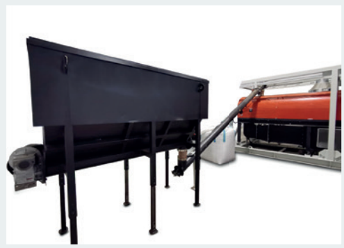
Einfülltrichter und Förderschnecke Materialaufnahme per Big Bag oder Radlader, mit optimalem Materialfluss über frequenzgeregelte Förderschnecke.
