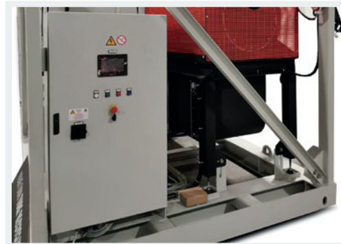
Steuer- und Bedieneinheit Zentrale Einheit mit programmierbare Logik und modularer Schnittstellentechnik
