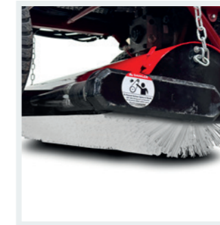
ROTATIONSBÜRSTE Zum Bürsten der Fasern und gleichzeitigen Einbürsten des Füllmaterials.
