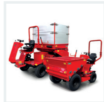
SCHNELLWECHSEL Der Fahrersitz mit Bedienelementen ist um 180° drehbar.
