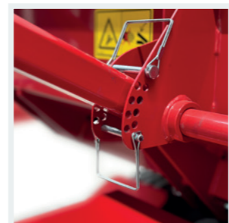
FUNKTIONAL Einfache Arretierung des Auslassventilhebels.
