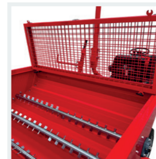
EFFEKTIV Vier hydraulisch angetriebene Paddelwellen im Behälter sorgen für die Lockerung des Einfüllmaterials und gleichmäßiges Ausbringen.
