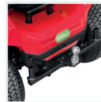
ANHÄNGERKUPPLUNG Für Schleppmatten, Dreiecksbesen und Magnetleisten.
