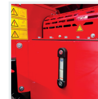
BETANKUNG Dieseltank mit Tankanzeige.
