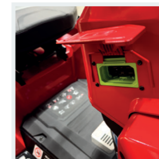
PRAKTISCH Kein Ausbau nötig, Anschluss zur direkten Ladung der Akkus.
