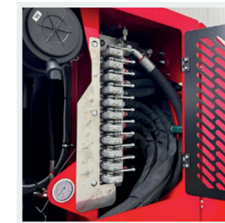
HYDRAULIK Zentraler Hydraulikblock mit Magnet- ventilen.
