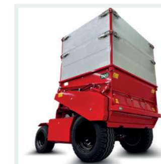
LEICHTFÜSSIG Vier großvolumige Rasenreifen für minimalen Flächendruck.
