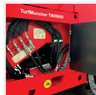
HYDRAULIK-SCHNELLKUPPLUNG für Antrieb von Förderband.
