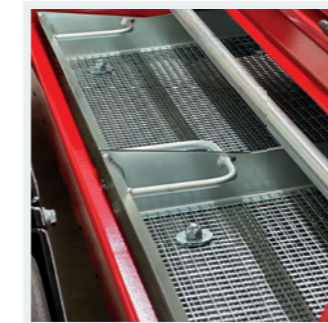
VARIABEL Stufenlos verstellbares Rüttelsieb (jetzt ohne Antriebswelle).
