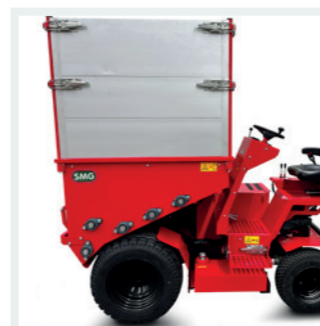
BORDWAND DREIFACH Maximales Fassungsvermögen von 3000 Litern.
