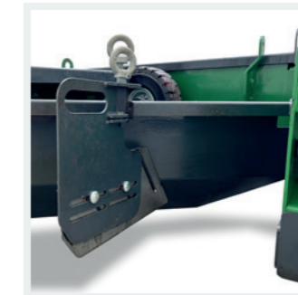
AUTOMATISIERUNG Verbesserte Leitbleche für weniger Handarbeit.
