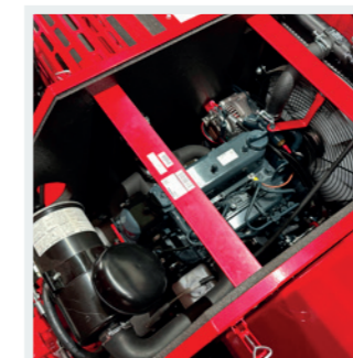
ZUVERLÄSSIG Der leistungsstarke 4-Zylinder-Kubota-Dieselmotor erbringt eine Leistung von 18,5 kW (25 PS).
