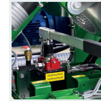
BEWÄHRT Handpumpe zum Anheben und Absenken des Mischerrohres
