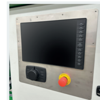
INNOVATIVE BEDIENUNG Ein 12-Zoll-Touchdisplay und die neu- este SMG-Software gewährleisten eine präzise und zuverlässige Steuerung aller Prozesse.
