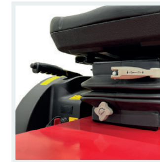
KOMFORT Gefederter und verstellbarer Fahrersitz.
