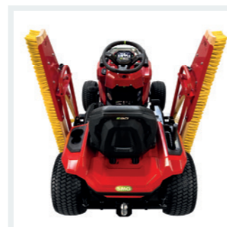
KOMPAKT Hochklappbare Dreiecksbesen.
