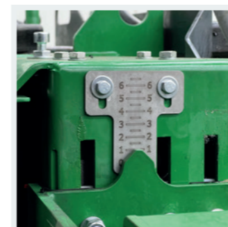
PRÄZISION Elektrische Spindeln an der Bohle mit Sensorik und Skala.
