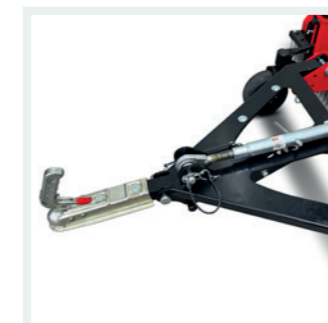
EINFACHER TRANSPORT Dreipunktaufhängung und Zugdeichsel in einem - für sicheren und einfachen Transport.
