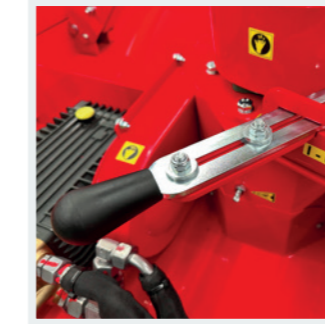
EINFACH Antriebshebel zum Einkuppeln des Gerätes.
