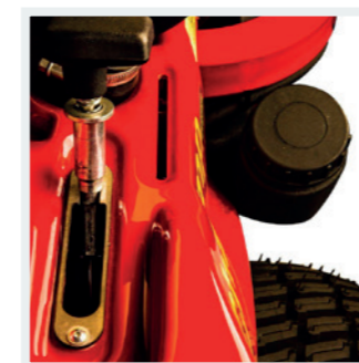
BETANKUNG Tankstützen außerhalb für 16 Liter Kraftstofftank.
