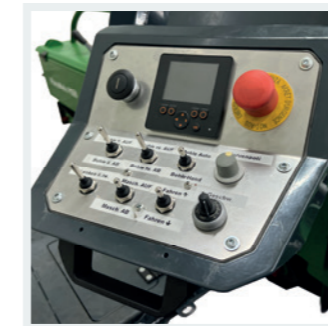
DIGITALISIERUNG Steuerpaneel mit Display für IOT und GPS Anwendung.
