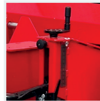
FUNKTIONAL Arbeitstiefeneinstellung, Verstellspindel, Höhenanzeige, Libellen.
