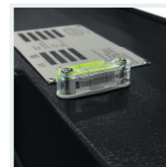
KONTROLLE der Bürstenebenflächigkeit und Maschinenneigung für optimale Reinigungsergebnisse.
