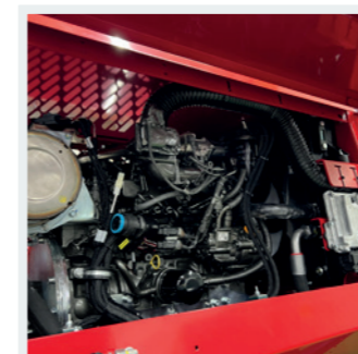
MOTOR 35 kW (46,2 PS) Dieselmotor für 25 - 30 % mehr Leistung zum Vorgän- germodell.
