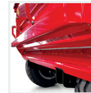
PRÄZISE Streuklappe über das Auslassventil einstellbar.
